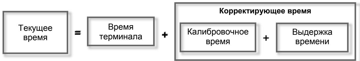
Рисунок 42 – Текущее время терминала (импульсная синхронизация PPS)
